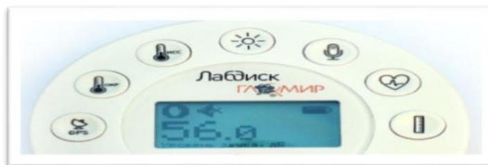
Рисунок 2 - Кнопки датчиков регистратора Labdisc
